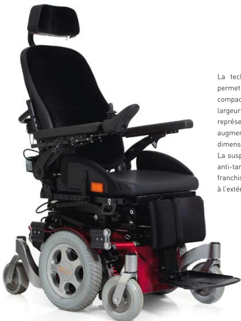
La technologie d'entraînement par roue motrice centrale permet au Salsa M d'avoir un rayon de braquage extrêmement compact pour une maniabilité optimale à l'intérieur. Son infime largeur veille à ce que les ouvertures de portes étroites ne représentent plus un obstacle et le rayon de braquage compact augmente la liberté de mouvement dans les espaces de petite dimension.
