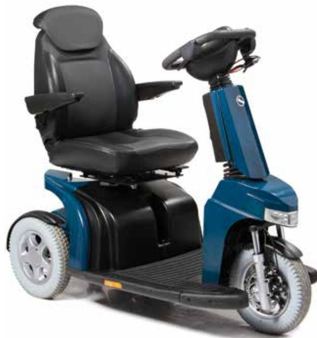
En plus de suspensions huilées à l'avant et à l'arrière, le Sterling Elite<sup>2</sup> est muni de pneus confortables de 14", ce qui lui permet de triompher sans aucun problème des irrégularités de la route.
