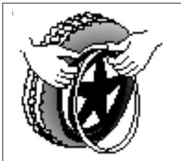
Coloque la cámara sin aire en torno al centro de la llanta. Asegúrese de que la válvula pase por el orificio correspondiente de la llanta.
