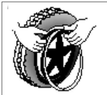
Legen Sie den Schlauch ohne Luftpumfung rundum in die Felgenmitte. Achten Sie darauf, dass das Ventil durch die Ventilöffnung der Felge hinausragt.
