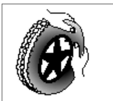
Liegt der Schlauch rundherum faltenlos im Reifen (wirft er Falten: etwas Luft ablassen), dann lässt sich die obere Reifenseite gegenüber dem Ventil beginnend, leicht mit beiden Händen aufs Ventil hin montieren.
