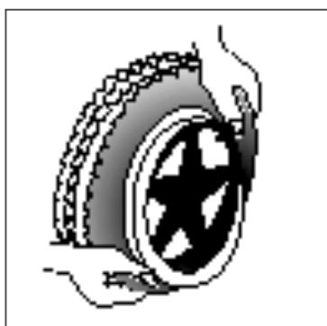
Prenez maintenant le pneu et enfoncez-le derrière la valve en commençant au-dessus du rebord de jante. Ensuite, gonflez légèrement la chambre à air jusqu'à ce qu'elle prenne sa forme ronde et se place dans le pneu.
