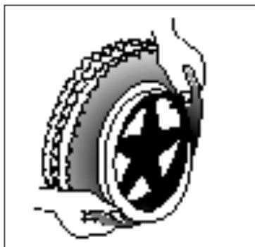
Nehmen Sie nun die Decke und drücken diese hinter dem Ventil beginnend über den Felgenrand. Dann den Schlauch schwach aufpumpen, bis er seine runde Form annimmt und in den Reifen einlegen.
