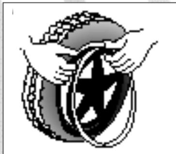
Leg de binnenband zonder lucht rond de velg. Let erop dat het ventiel door de ventielopening van de velg steekt.
