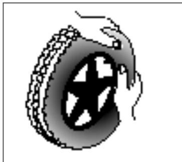
Si la chambre à air se place dans le pneu sans le moindre pli sur toute la périphérie (si des plis se forment : laissez s'échapper un peu d'air), vous pouvez poser la face supérieure du pneu, en commençant du côté opposé à la valve, en appuyant légèrement avec les deux mains sur la valve.
