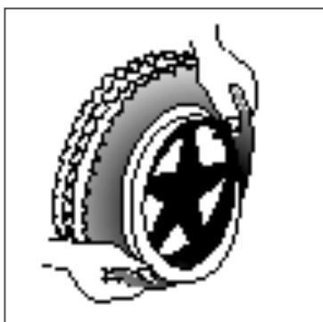
Tome ahora la cubierta y presiónela detrás de la válvula, empezando por el borde de la llanta. Después, bombee un poco de aire en la cámara hasta que alcance su forma redondeada y colóquela en la rueda.
